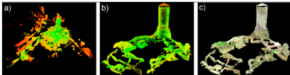
Rys. 2. Chmury punktów przed filtracją (a) i po filtracji: w barwach wyrażających intensywność odbicia wiązki lasera (b), z nałożoną teksturą ze zdjęć wykonanych skanerem (c).
